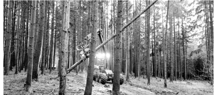
Der Vollernter bringt mithilfe des Greifarms die Bäume sicher und kontrolliert zu Boden. Das Entasten und Zuschneiden der Stücke folgt direkt darauf.
